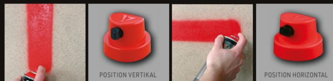
Breites und sauberes Sprühbild, ähnlicher Farbauftrag wie bei einer Spritzpistole. Die Sprühdüse kann variabel eingestellt werden. Bitte beachten Sie die Sprühbewegungen je nach Düseinstellung. Sprühabstand zum Objekt ca. 15 cm
